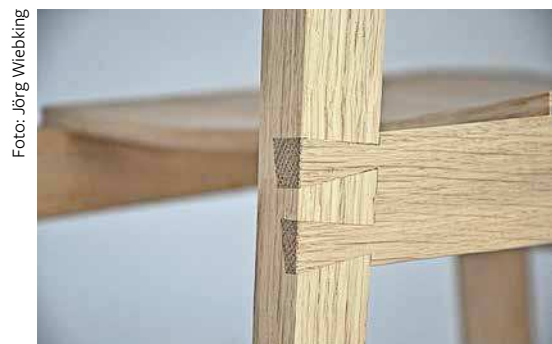
Langlebig durch hochwertiges Handwerk: Die Schwalbenschwanz-Verbindungen garantieren anhaltende Stabilität.
