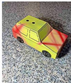
In diesem Workshop probieren Jugendliche gleich drei Berufe aus: den Metallbau mit der Herstellung der Fahrzeugkarosserie aus Stahlblech. Anschließend kommt für die Lieblingsfarbe die Airbrush-Technik der Fahrzeuglackierer zum Einsatz. Beim Installieren der Solarbeleuchtung runden Aufgaben des Elektrotechnikers das Werkstück ab. So leuchtet das Auto in der Nacht – ganz nachhaltig und ohne Strom.
