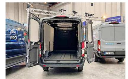
Das Ladevolumen der elektrischen Transit gleicht dem der Diesel-Varianten – Akku im Wagenboden sei Dank.
