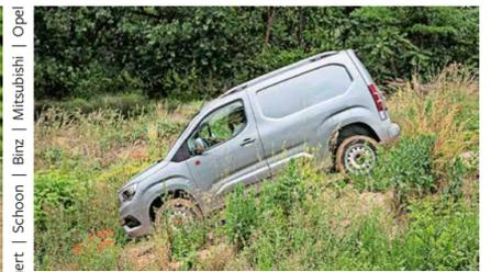
Ein SUV bleibt hier stecken: Der Opel Combo Cargo 4x4 steckt dank Allradantrieb und bis zu 110 Millimetern zusätzlicher Bodenfreiheit einiges weg.
