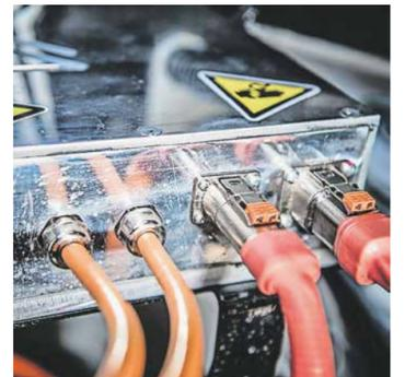
Spannungsquelle: Die Hochvoltbatterie ist wahlweise mit 40 und 55 kWh zu haben.
