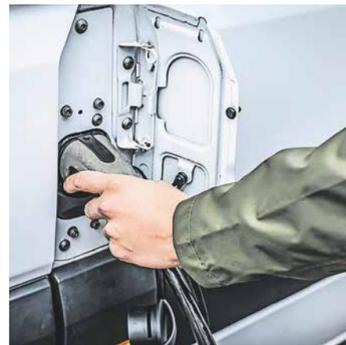
An einer 22 kWh-Schnellladestation ist die kleine Batterie in zwei Stunden geladen.
