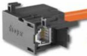
Die RJ45-Buchse ist bei 3-Punkt-Zählern auf der Zählertragschiene zu befestigen. (Mind. 30 cm Freie Leitungslänge.)
