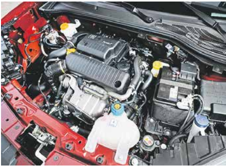
120 PS und 205 Newtonmeter mobilisiert der 1,4 Liter große Motor.
