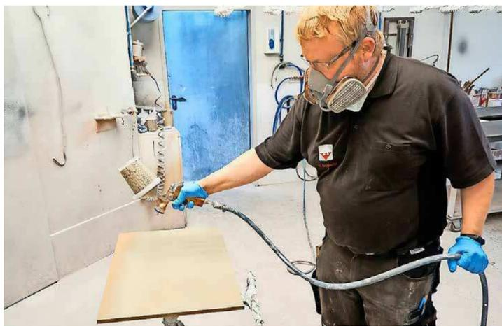
Anschluss des Kompressorschlauchs auf. Der ist beim neuen Gerät beweglich gelagert. Ein willkommenes Feature, denn „auch ein Luftschlauch hat eine gewisse Steifigkeit und kann, wenn er starr am Gerät hängt, gegen die gewollte Spritzbewegung arbeiten“, erklärt Wehrhahn. Mit dem beweglichen Anschluss lasse sich die Pistole freier bewegen.
