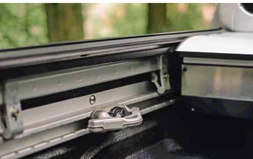
Praktisch: Die Ladefläche bietet variable Befestigungsösen und eine Abdeckung.
