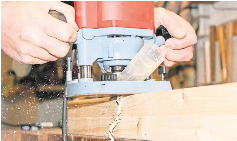
Durch das Gewicht und die breite Grundplatte lässt sich die Maschine gut führen.
