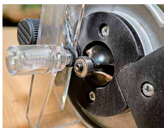
Bei der Massivholzbearbeitung mit handelsüblichen Fräsern verhindert die Anlaufbremse, dass der Anlaufing Spuren an der Kante hinterlässt.
