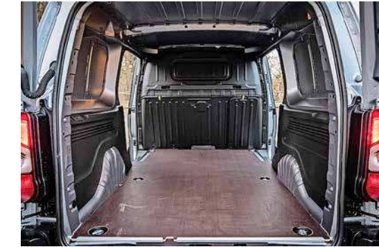
Versteckte Kraft: Durch die unterflur angebrachten Akkus bleibt der Laderaum des e-Partners unangetastet.
